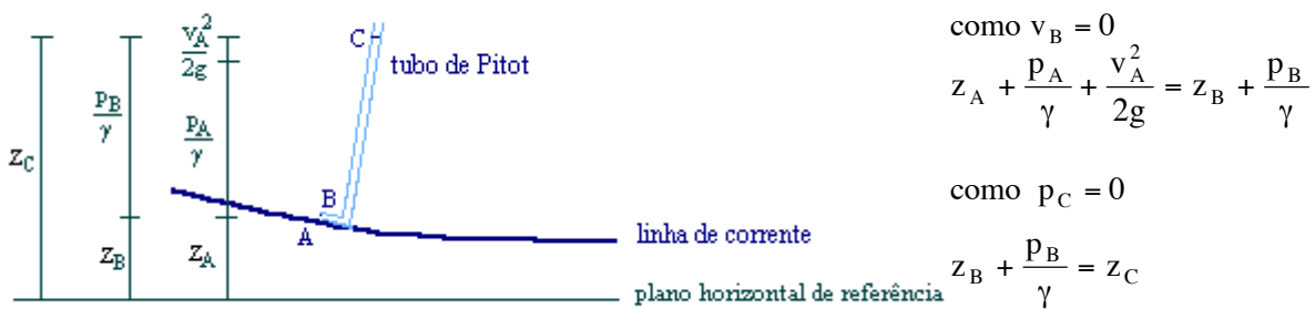
Figura 4.5 Tubo de Pitot. Transferência de energia.
